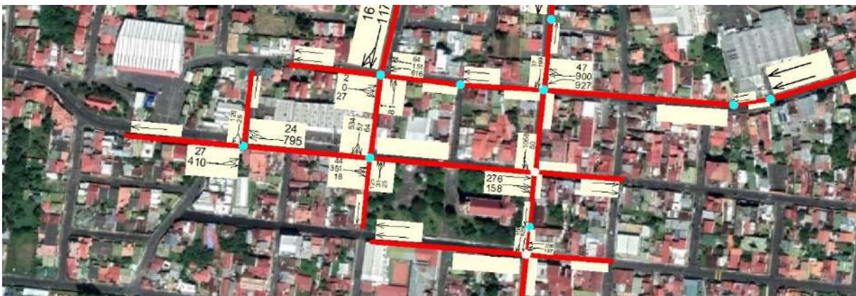
Figura 16. Red vial modelada en el programa Synchro 6. Datos de la hora pico a.m.
