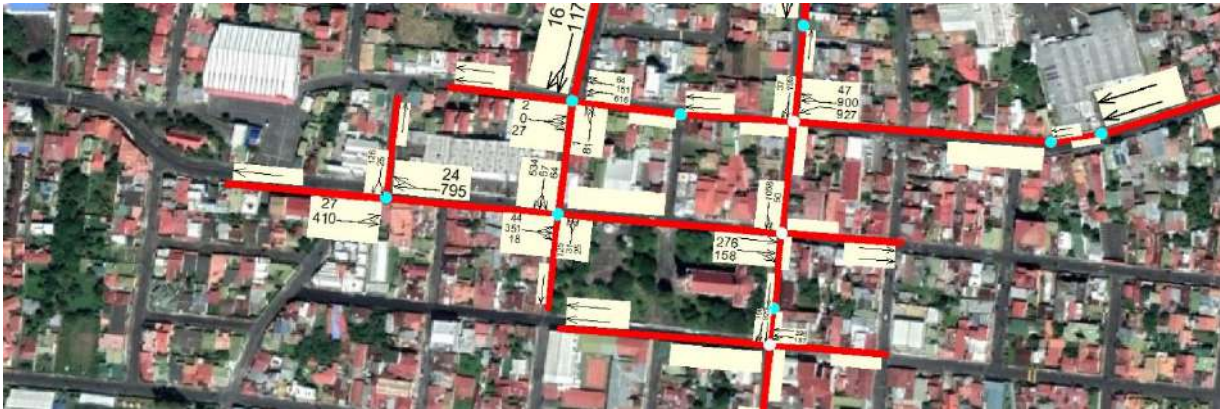
Figura 17. Red vial final optimizada en el programa Synchro 6. Datos de la hora pico a.m.
